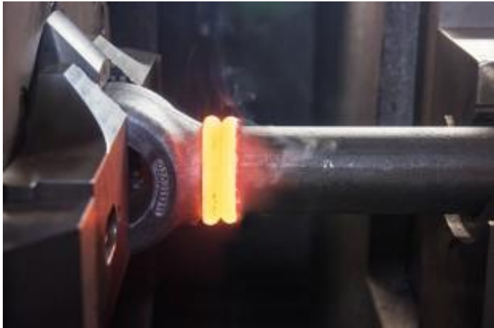
Hidrolik Piston Rod Kaynağı,
