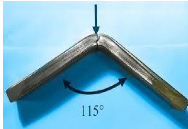
Kaynak dikişinden bükme çatlak testi.
