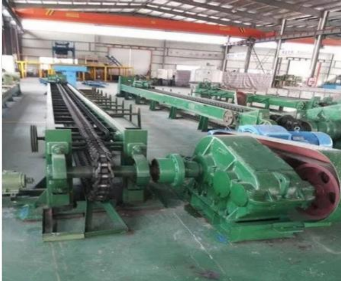
Gemi zinciri çekme testi kanalı 27.5 m. (Chain Cable test channel/Bench)
