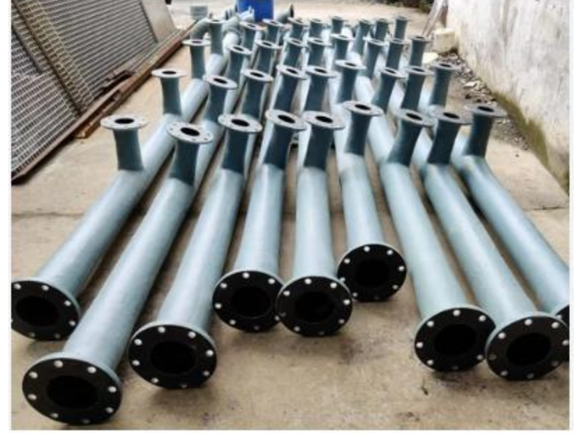
Gemi Ballast devrelerinde kullanılan GRP Borular
