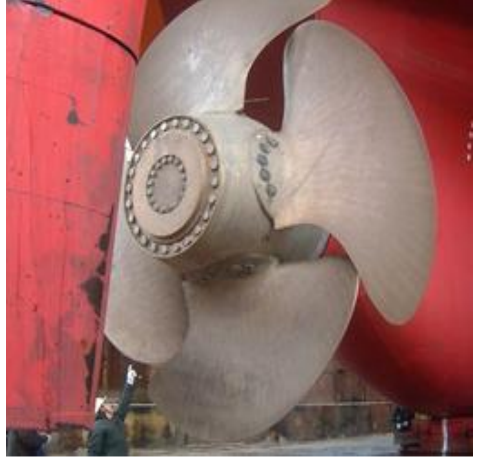
2- Kanat açısı ayarlanabilir pervane (CPP) Controlable Pitch Propeller
