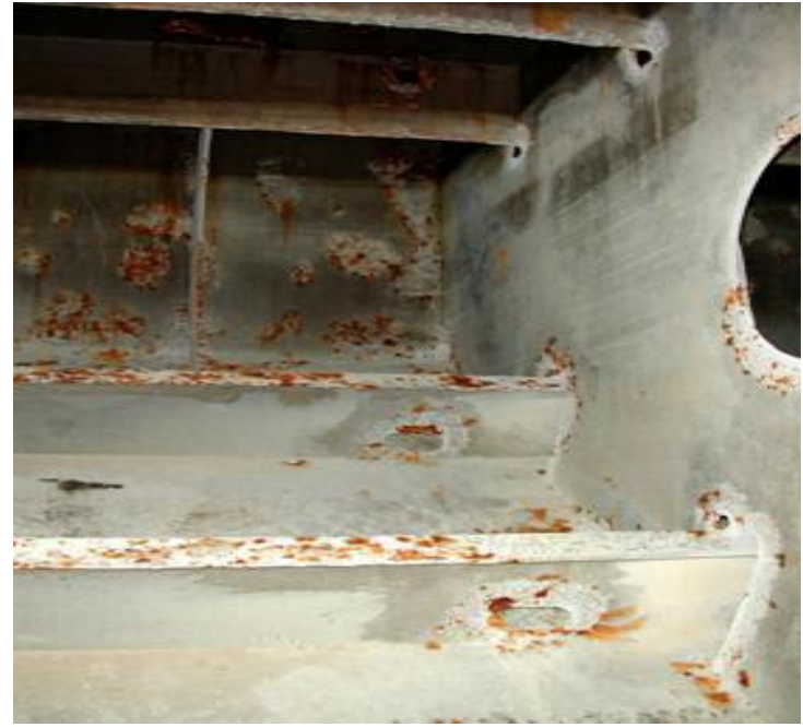
Fair Coating Top side Ballast tank. Raspa edildi, sac ölçüsü alındı, tamir edilip touch-up boyandı
