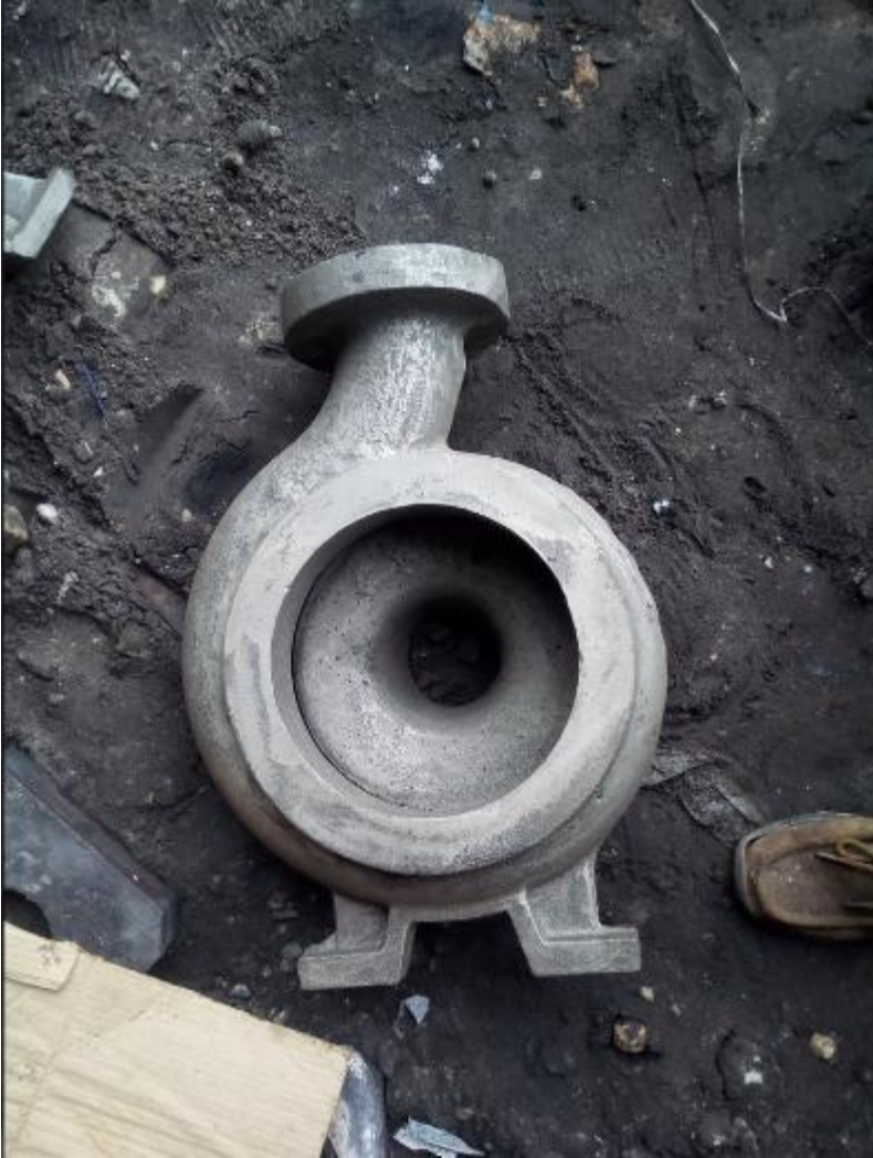
Pompa ve Valf bedeni Çelik Döküm. Pump case and Valve Body Cast Steel,
