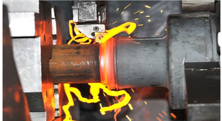
Şaft ve Kaplin Kaynağı.(taşan metal torna ediliyor)
