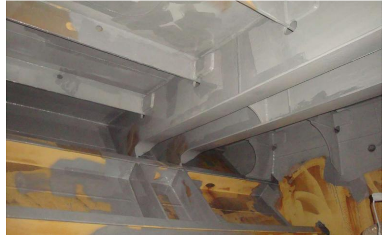
Fair Coating Top side Ballast tank. Raspa edildi, sac ölçüsü alındı, tamir edilip touch-up boyandı
