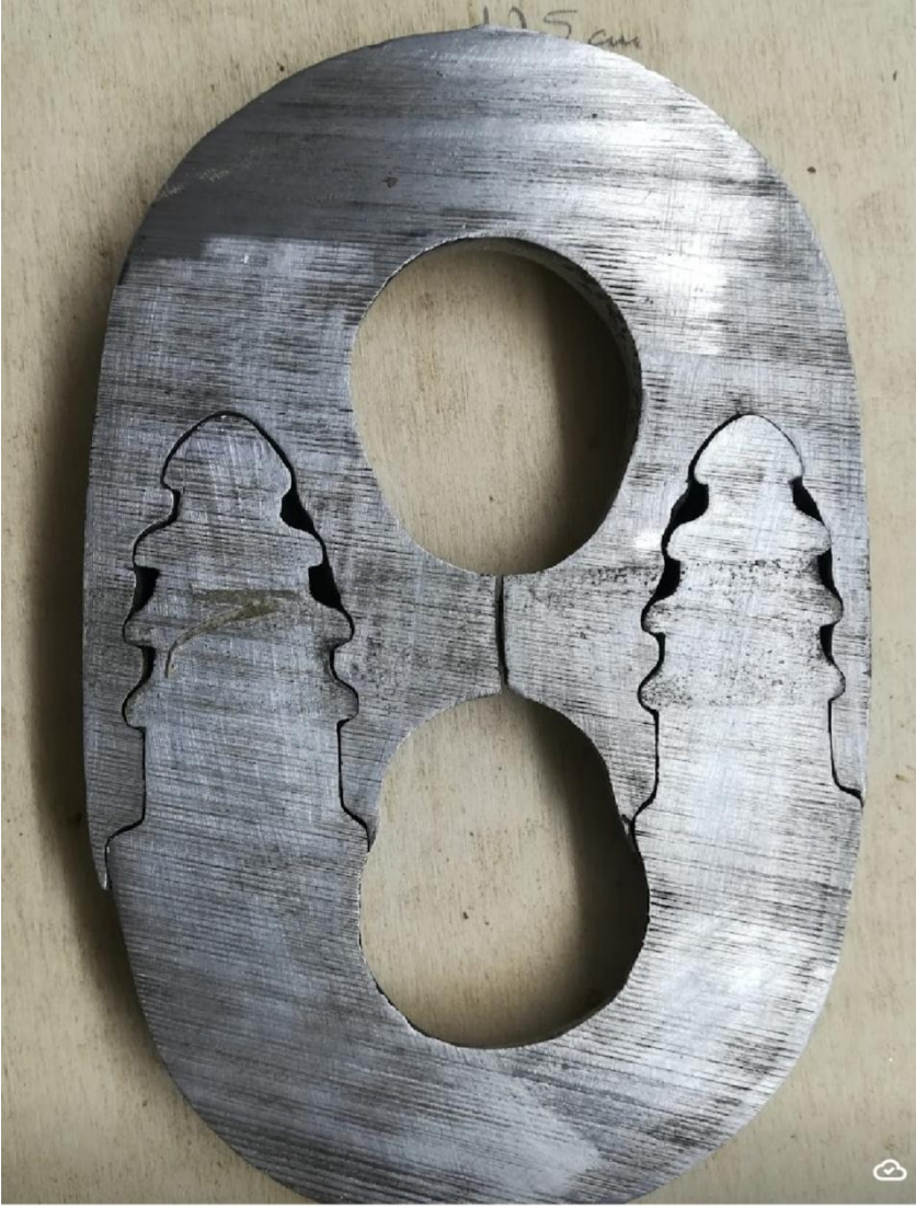
Dövme Çelik DIE-LOCK ANCHOR CHAIN Lokması Kesit görünümü.
