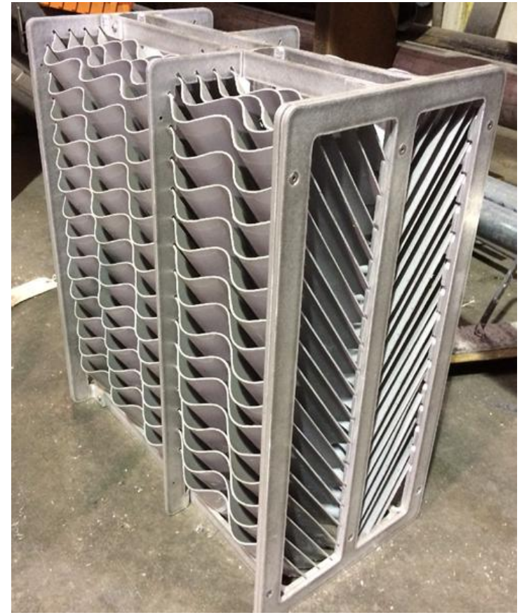
Temas yüzeyi arttırılmış SS Cross-Flow Corrugated Plate of 15 ppm Marine Oily Water Bilge Separator.
