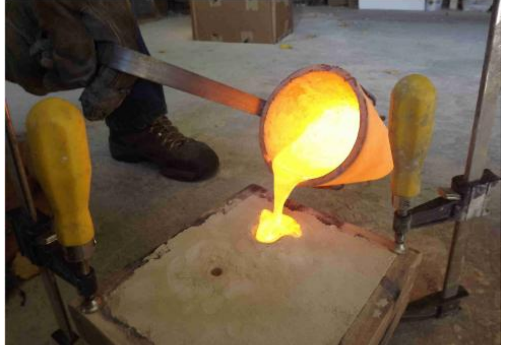
Kum kalıba döküm, (Sand Molded Casting)
