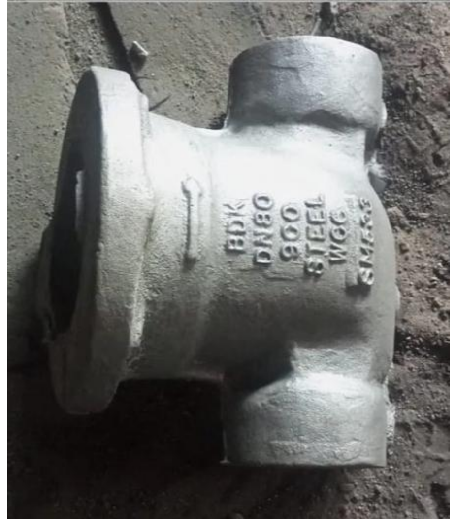
Pompa ve Valf bedeni Çelik Döküm. Pump case and Valve Body Cast Steel,
