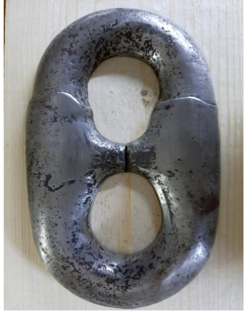
Dövme Çelik DIE-LOCK ANCHOR CHAIN Lokması Kesit görünümü.
