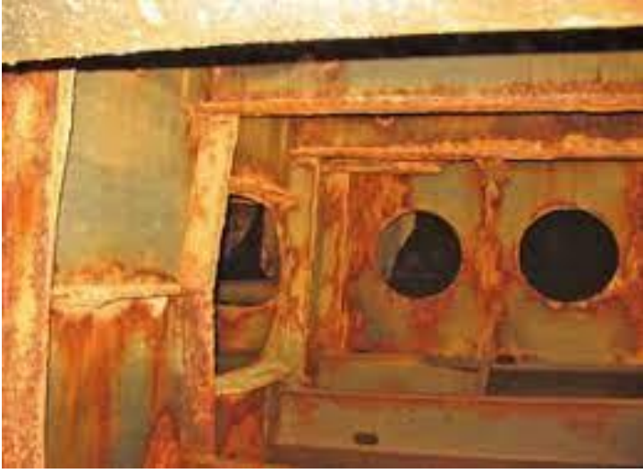
Poor Coating DB. Ballast tank. Raspa edildi, sac ölçüsü alındı, gerekli tamir edilip full boyandı.
