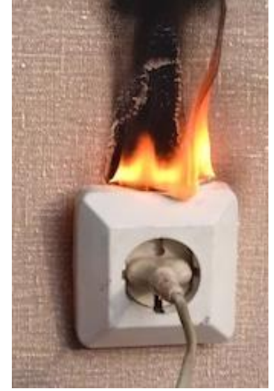
Uzatma Kablosu ve duvar Prizi yangını.
