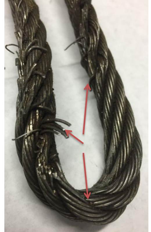
Radansa olmadan kullanılan hasarlanan halat kasası
